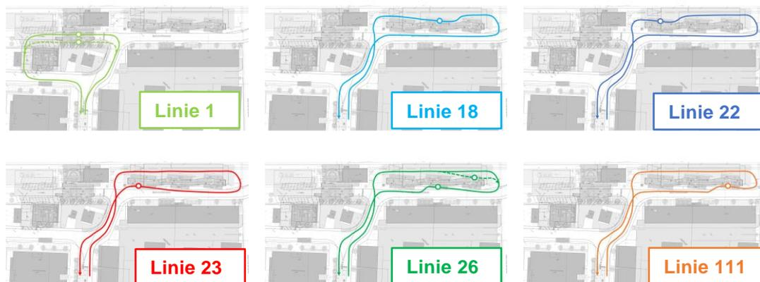
Abbildung 6: Betriebskonzept und Haltekantenanordnung
