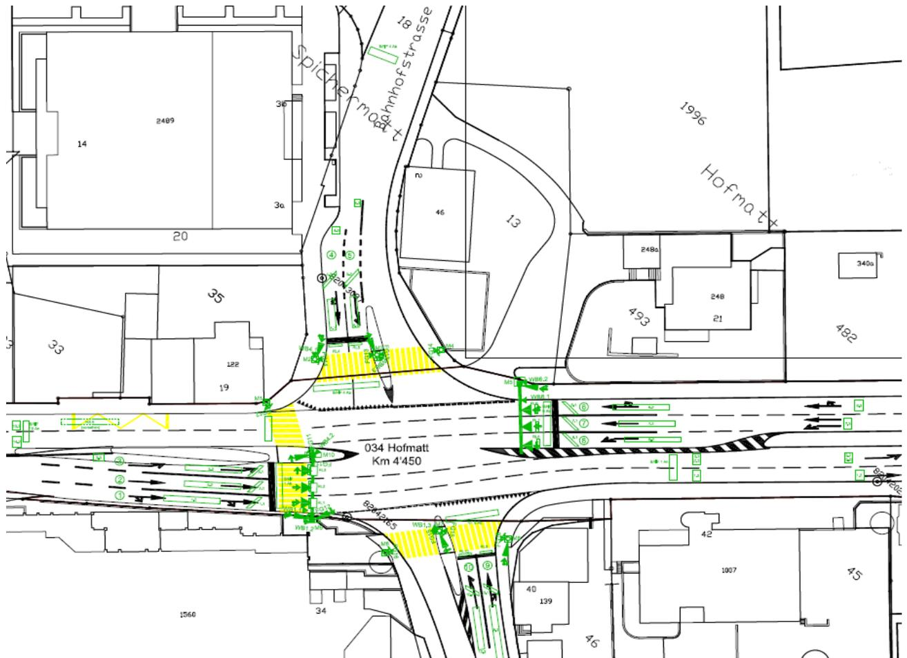
**Abbildung 2: Ausschnitt aus dem Signallageplan (Ausschnitt Bahnhofstrasse nicht aktuell)**
