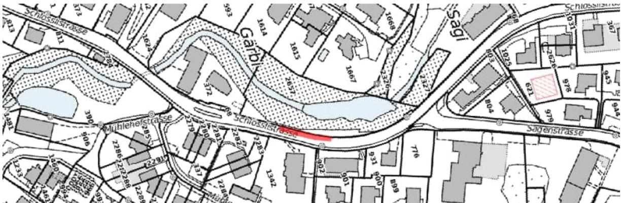
Die Bauarbeiten finden unter Verkehr statt. Die Fahrspur bergaufwärts muss tagsüber gesperrt werden. Während der Arbeitszeit wird der Verkehr durch den Verkehrsdienst geregelt. Ausserhalb der Arbeitszeit und über Nacht wird der Bereich geräumt und der Strassenrand mit Leitbacken gesichert. Die Arbeiten sollten innerhalb einer Woche erledigt sein.
